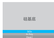
N型多晶硅沉积后
